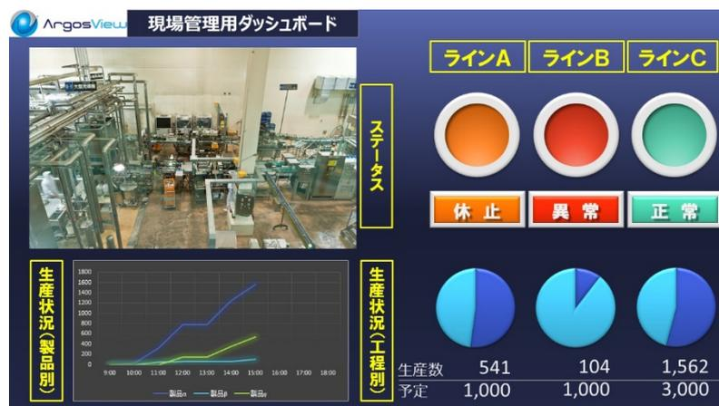
生産現場・物流現場の監視カメラ映像と、PLC（生産設備の制御装置）や作業管理システム上の生産設備情報・作業進捗状況を統合。一覧表示することで、現場のトラブルや作業遅延を可視化します。
